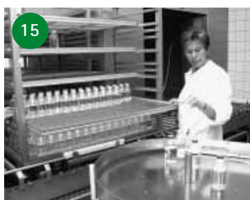
15 Apothekenarbeiterin Erika Manthey überprüft die Arbeit der Bördelmaschine und stellt die fertigen Flaschen auf den Transportwagen.
