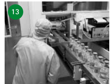
13 Durch die Öffnung vorne laufen die frisch abgefüllten Flaschen direkt zur Bördelmaschine.
