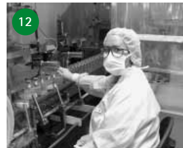
12 Unter einer Vorrichtung, die partikelarme und verwirbelungsfreie Luft garantiert, wird die Lösung abgefüllt und sofort mit einem Stopfen verschlossen, 500 Flaschen/Stunde.
