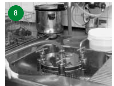
8 Jetzt werden Filter vorbereitet, denn die Lösung wird vor dem Abfüllen zweimal gefiltert (1 Vorfilter und 1 Sterilfilter).
