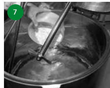
7 Alle Komponenten werden in den Kessel eingefüllt und dort dann mindestens 15 Minuten lang gerührt. Damit ist die Infusionslösung im Grunde schon fertig.
