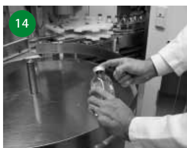
14 Die Bördelmaschine verschließt die Flaschen. Der Stopfen kann jetzt nicht mehr herausfallen.
