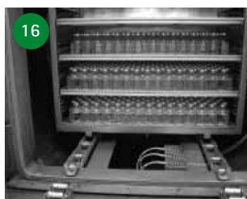
16 Jetzt kommt alles zur Sterilisation in den Autoklav, wo es auf 121,5 ° C für 15 Min erhitzt wird. Mit Aufheizen und Kühlen dauert das eine Stunde.
