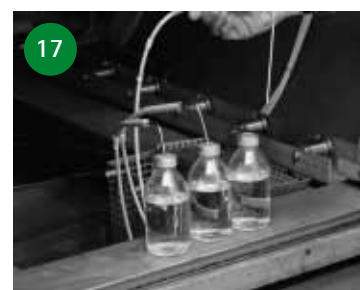
17 Durch solche Temperaturfühler wird die Temperatur während der Sterilisation überwacht.
