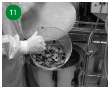
11 Derweil gehen im Reinraum die Vorbereitungen für das Abfüllen weiter. Hier werden die Verschlussstopfen nochmals gespült.
